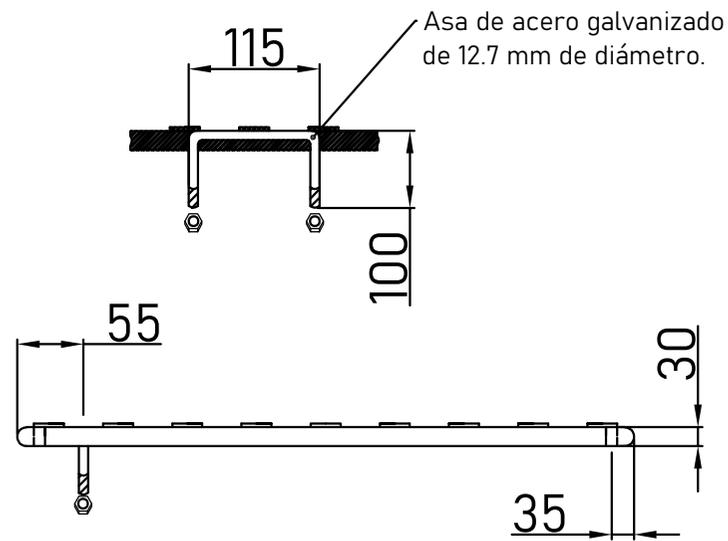
Asa de acero galvanizado de 12.7 mm de diámetro.
